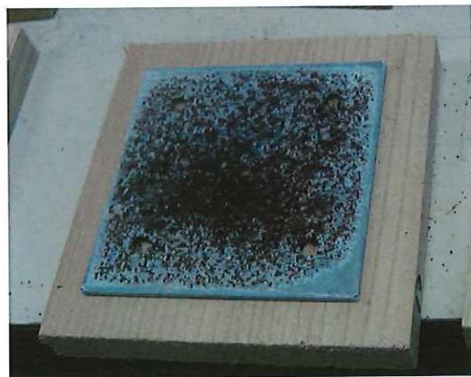
写真 1.3.6 保存処理剤が影響した金属の腐食の様子
