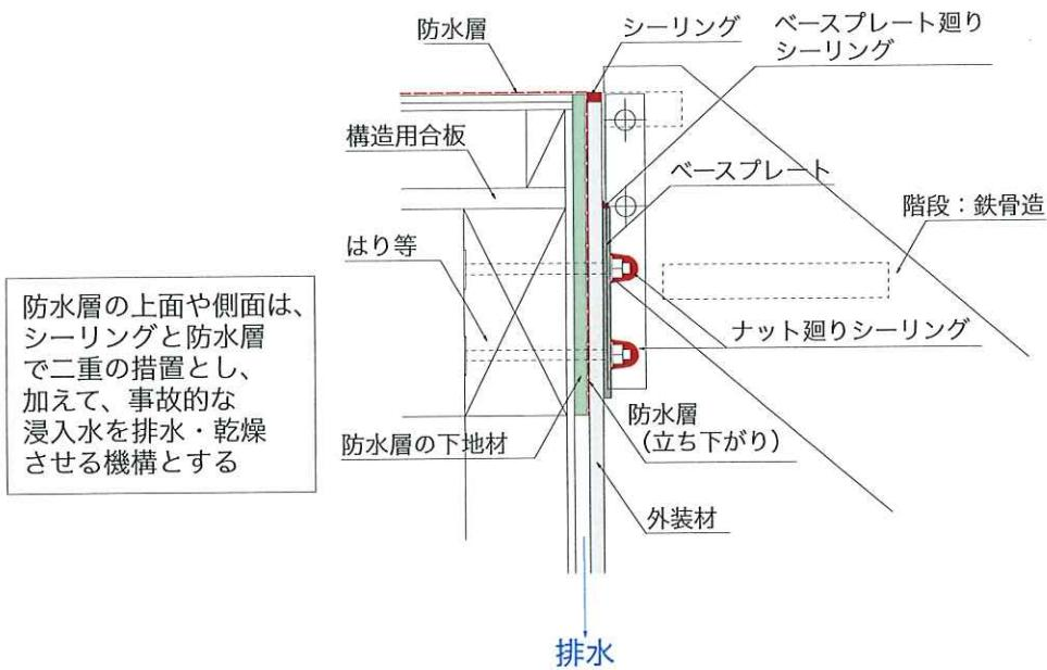
図 1.5.2 鉄骨の屋外階段と建築物の木造部分との接合部における
