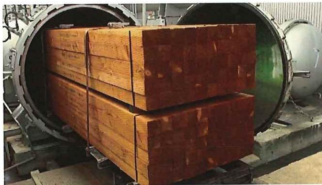
写真 1.3.1 薬剤を加圧処理する注薬缶
