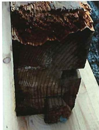
写真 1.2.3 水分の浸入により木材が腐朽した様子
